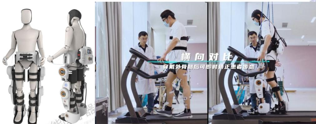
图 26 “神工·神甲”脑机接口神经肌肉电刺激下肢外骨骼康复训练机器人
